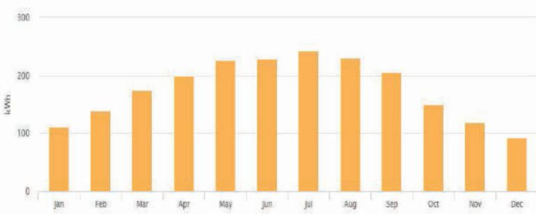
Estudo de produção mensal considerando instalação com inclinação de 30° orientada a Sul.
