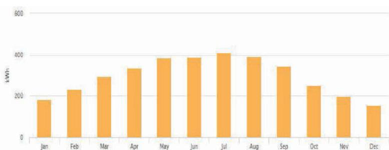
Estudo de produção mensal considerando instalação com inclinação de 30° orientada a Sul.
